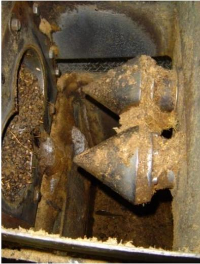
Si se reduce la capacidad de prensado y el ducto de alimentación no se encuentra obstruido debe disminuirse la presión axial del cono y adicionar nueces para facilitar el paso del material.
